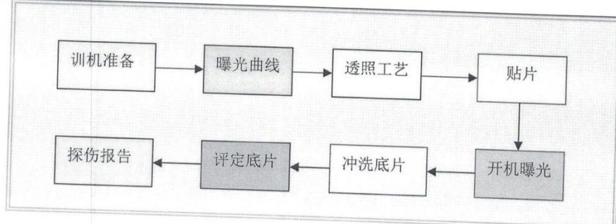
图 2-3 X 射线探伤工艺流程示意图
