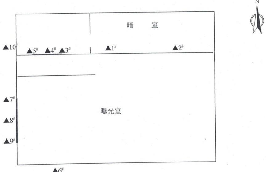
图 探伤室周围X( $\gamma$ )辐射空气吸收剂量率监测布点示意图
