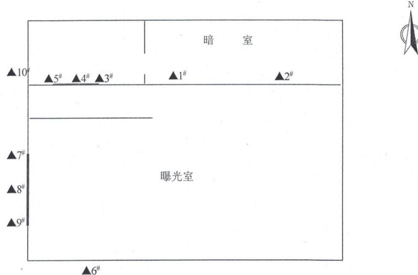
图 5-3 探伤室周围 X ( $\gamma$ ) 辐射空气吸收剂量率监测布点示意图
