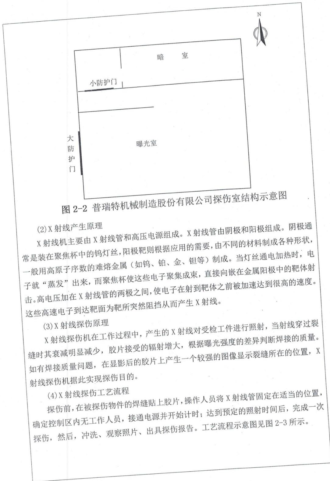
图 2-2 普瑞特机械制造股份有限公司探伤室结构示意图
